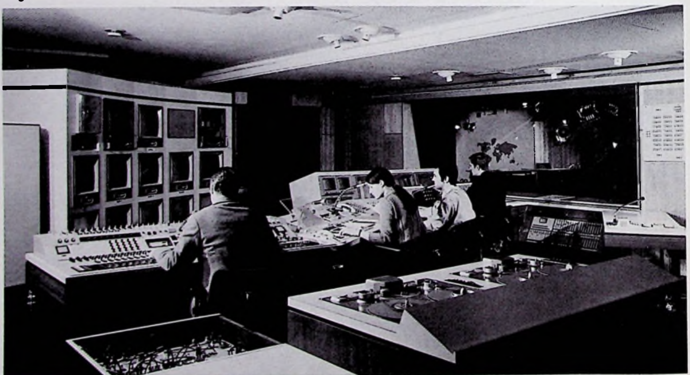
Regieraum eines Fernsehstudios für aktuelle Sendungen. Links im Vordergrund der Toningenieur. (Bilder: NDR)
